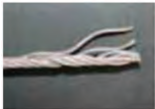
EFFILOCHAGE Câble visiblement distendu ou déroulé
